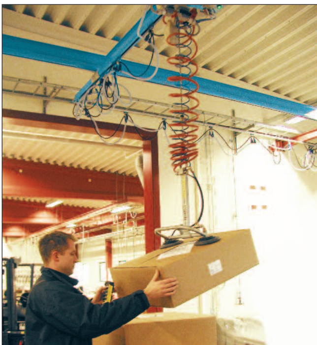
VACU-COMB Vakuumlyftare för hantering av kartonger med manuellt tilt 90°, försedd med PMH Radiostyrning för till- och frånslag av vakuumlyftaren.
