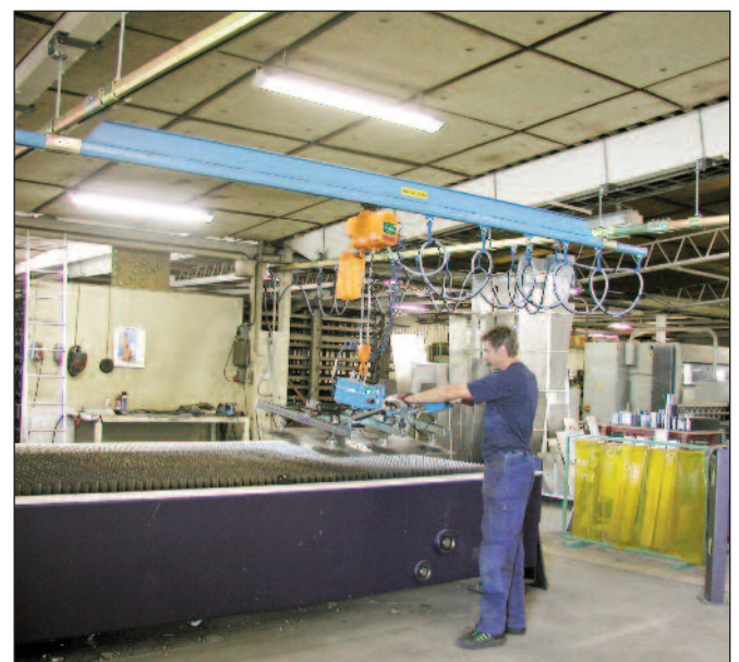
VACU-COMB Vakuumlifter, KITO Kättingtelfer monterad i PMH Lättprofiltravers.
