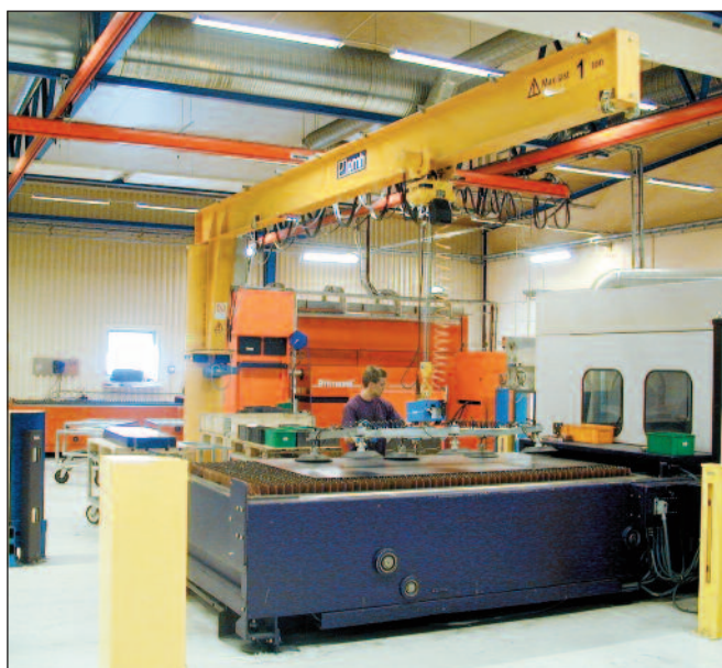
VACU-COMB Vakuumlifter, PMH Classic kättingtelfer monterad i PMH Meister pelarsvängkran som är utrustad med PMH Radiostyrning.
