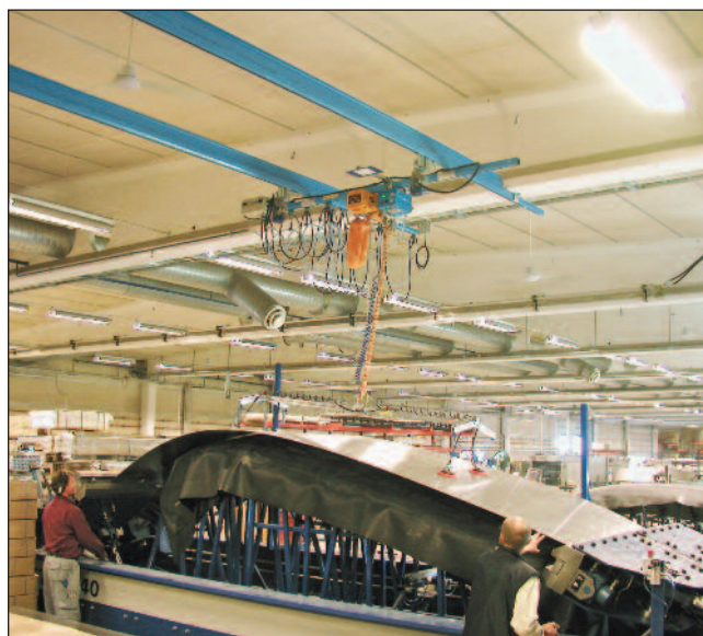
VACU-COMB Vakuumlyftare för hantering av båtskrov.
