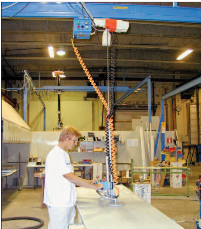
VACU-COMB Vakuumlyftare för hantering av dörrar med manuell tilt 90°.
