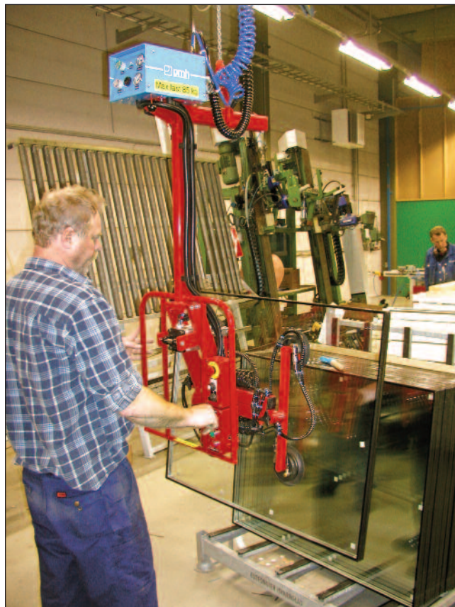
VACU-COMB Vakuumlyftare för hantering av fönster med manuell vridning ±90° och pneumatisk tilt 15°.
