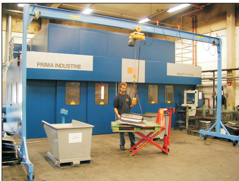
PMH Bockkran utrustad med PMH Classic elektrisk kättingtelfer.
