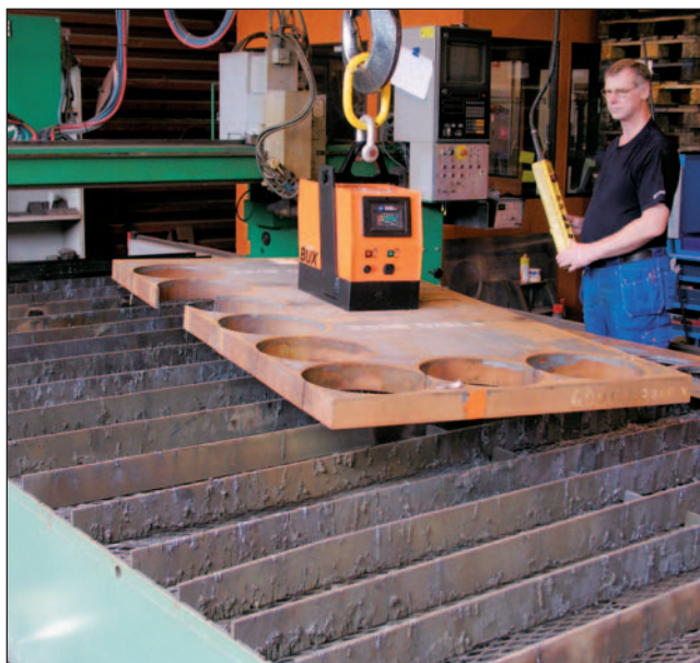
BUX BM Batterilyftmagnet för lyft av plant material.
