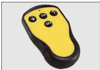
T70 STL sändare med stötupptagande gummiskydd.
