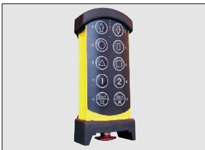
10 knapparsändaren har en drifttid på över 30 timmar och låg egenvikt.
