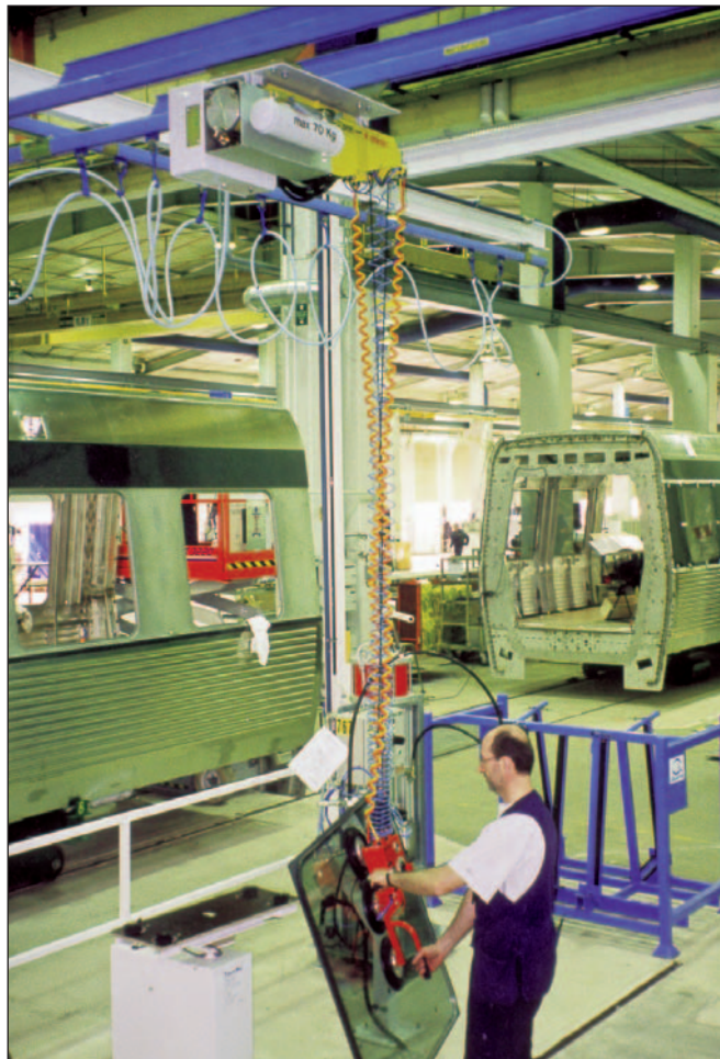
Minipartner med kundanpassat vakuumpverktyg för viktlos hantering av glasrutor.
