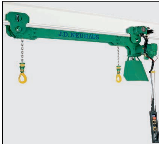
PMH Profi BBH med två synkrona lastkrokar för lyft av t ex axlar eller gods med dubbla lyftpunkter.
