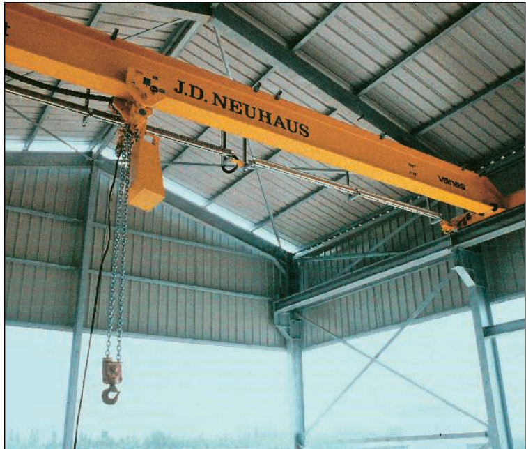
PMH Profi TA luftdriven travers i Ex-utförande som även kan utrustas med PMH Radiostyrning för säker och behörig manövrering.
