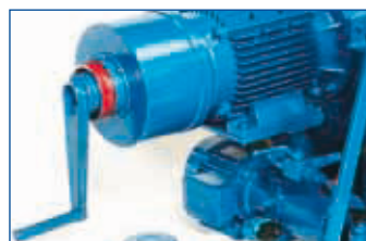
Nödkörning med spak via elmotorn
