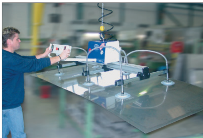
VacuMaster Comfort , 250 kg. Lyft vid metallbearbetningsmaskin.
