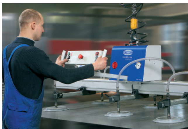
VacuMaster Comfort , 750 kg. Lyft av stora plåtskivor.
