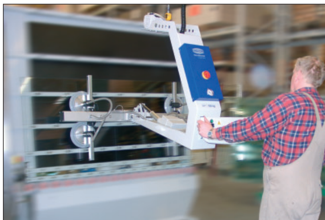
VacuMaster Comfort , 125 kg med 180° tiltning. Lyft vid glastvätt.
