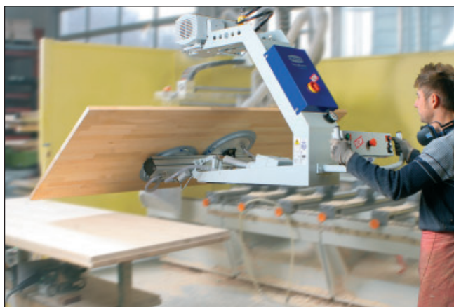
VacuMaster Comfort , 125 kg med 180° tiltning. Lyft av träskivor vid CNC-maskin.
