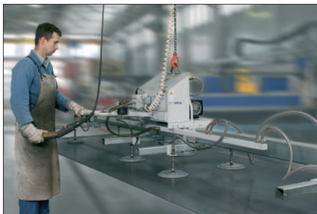
VacuMaster Vario , 1000 kg. Lyft vid skärmaskin.
