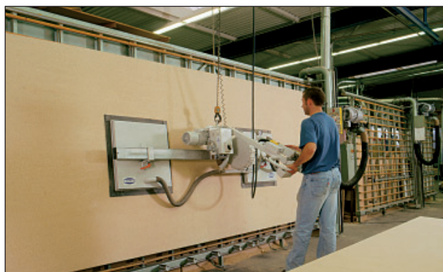
VacuMaster Multi , med vakuumfläkt för lyft av porösa skivmaterial.
