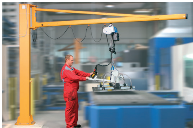
VacuMaster Basic , 250 kg. Lyft av rostfria plåtar.
