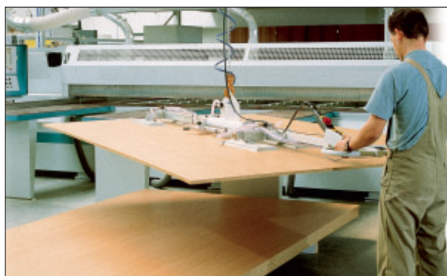
VacuMaster HHVM , med pneumatisk ejektor, manuell sidtillt 90°.
