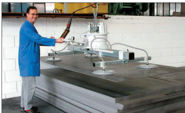
VacuMaster Eco , med självalstrande vakuum för lyft av täta material.
