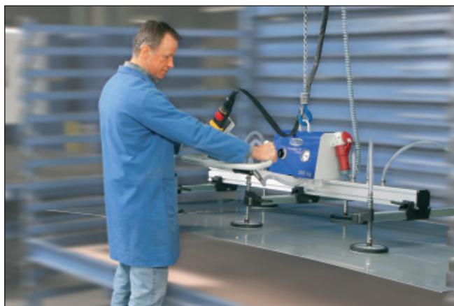
VacuMaster Basic , 250 kg. Lyft vid plåtbyrå.
