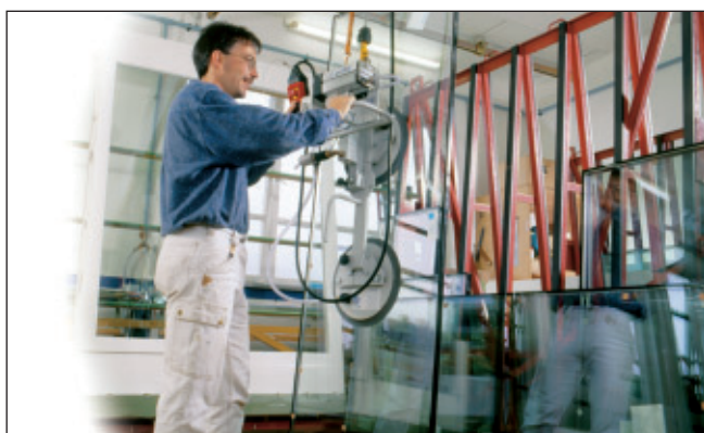
VacuMaster Window , med vakuumpump, manuell vridrörelse 90°.
