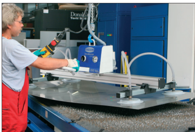
VacuMaster Basic , 250 kg. Lyft av plåtar.
