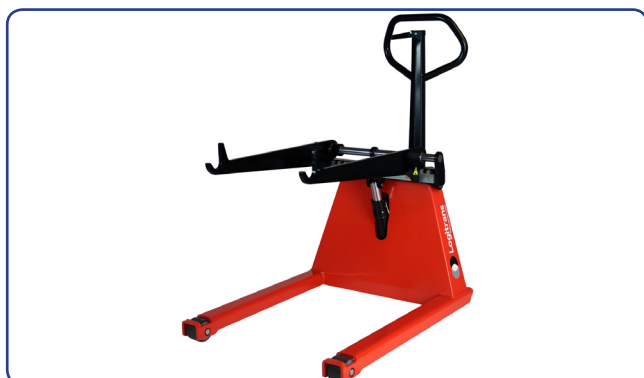
Rullyftarens snäva och korta ben gör det möjligt att ta rullen den sista biten in i maskinen.
