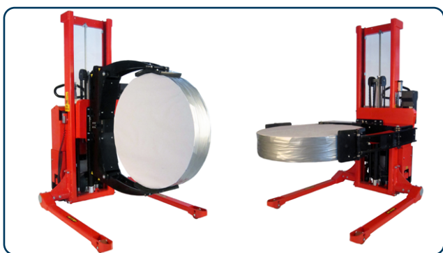
Rullrotatorn hanterar rullar både vertikalt och horisontell position
